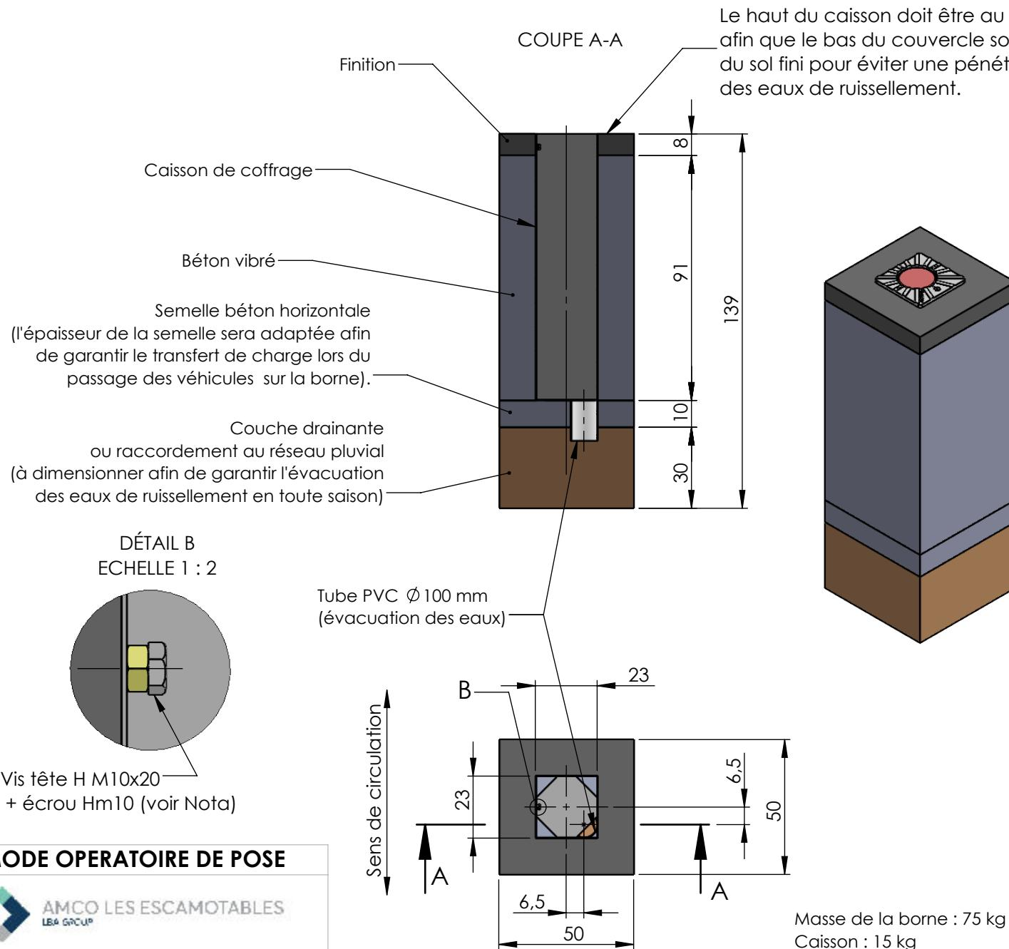
Le haut du caisson doit être au niveau du sol fini afin que le bas du couvercle soit toujours au-dessus du sol fini pour éviter une pénétration importante des eaux de ruissellement.
