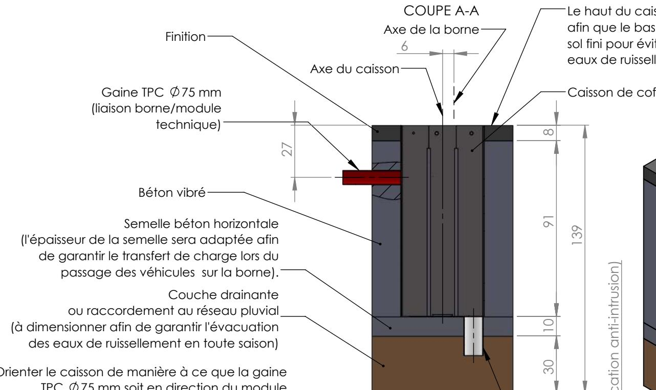
Orienter le caisson de manière à ce que la gaine TPC Ø 75 mm soit en direction du module technique. Réaliser la liaison équipotentielle entre le chassis et le module technique et la mise à la terre selon la norme en vigueur.
